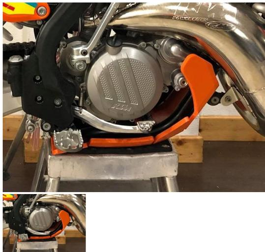
Cubrecarter dtc Polisport Ktm, protector de motor Ktm irrompible y sin vibraciones.
